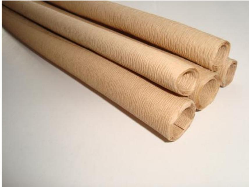
按国家标准：“用来使器件在电气上绝缘的材料”。也就是能够阻止电流通过的材料。它的电阻率很高，通常在 $10\sim 10^9\Omega\cdot m$ 的范围内。其特性主要包括以下几条：耐化学侵蚀具光泽，部份透明或半透明大部分为良好绝缘体重量轻且坚固加工容易可大量生产，价格便宜用途普遍、效用多、容易着色、部分耐高温存放货物可以起到防潮的效果。影响绝缘皱纹纸的主要指标如下：
