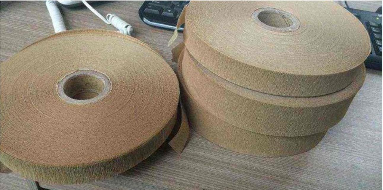
绝缘皱纹纸的种类 有浸渍绝缘纸、电力电缆纸、通讯电缆纸、半导体电缆纸、电话纸、电绝缘纸板、卷缠绝缘纸、电解电容器纸、电容器纸、皱纹电缆纸、聚酯复合绝缘纸、双层双密度干电解电容器纸、110~330kV高压电缆纸、500kV超高压电缆纸、瓷介电容专业卡纸、电池隔膜纸、H级电绝缘纸、电池隔膜原纸、自熄性浸渍绝缘纸、50kV电器匝间绝缘纸、50kV油纸套管绝缘纸、绝缘皱纹纸、未浸渍衬垫纸板。绝缘皱纹纸材料主要是用塑料做成板材，塑料为合成的高分子化合物，可以自由改变形体样式。塑料是利用单体原料以合成或缩合反应聚合而成的材料，由合成树脂及填料、增塑剂、稳定剂、润滑剂、色料等添加剂组成的，它的主要成分是合成树脂。用作电缆、线圈等各项电器设备的绝缘材料。
